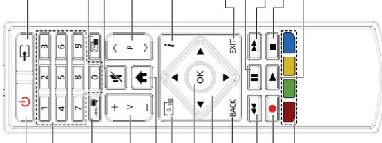
1. **Standby:** Schaltet das Fernsehgerät Ein / Aus
