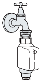
tuyau d'alimentation de sécurité
